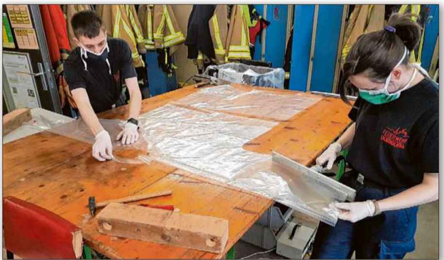
Der Folienrohling wird durch die Fertigung der Ärmel-Nähte mit einer Folienschweißzange zu einem funktionsfähigen Schutzkittel.
