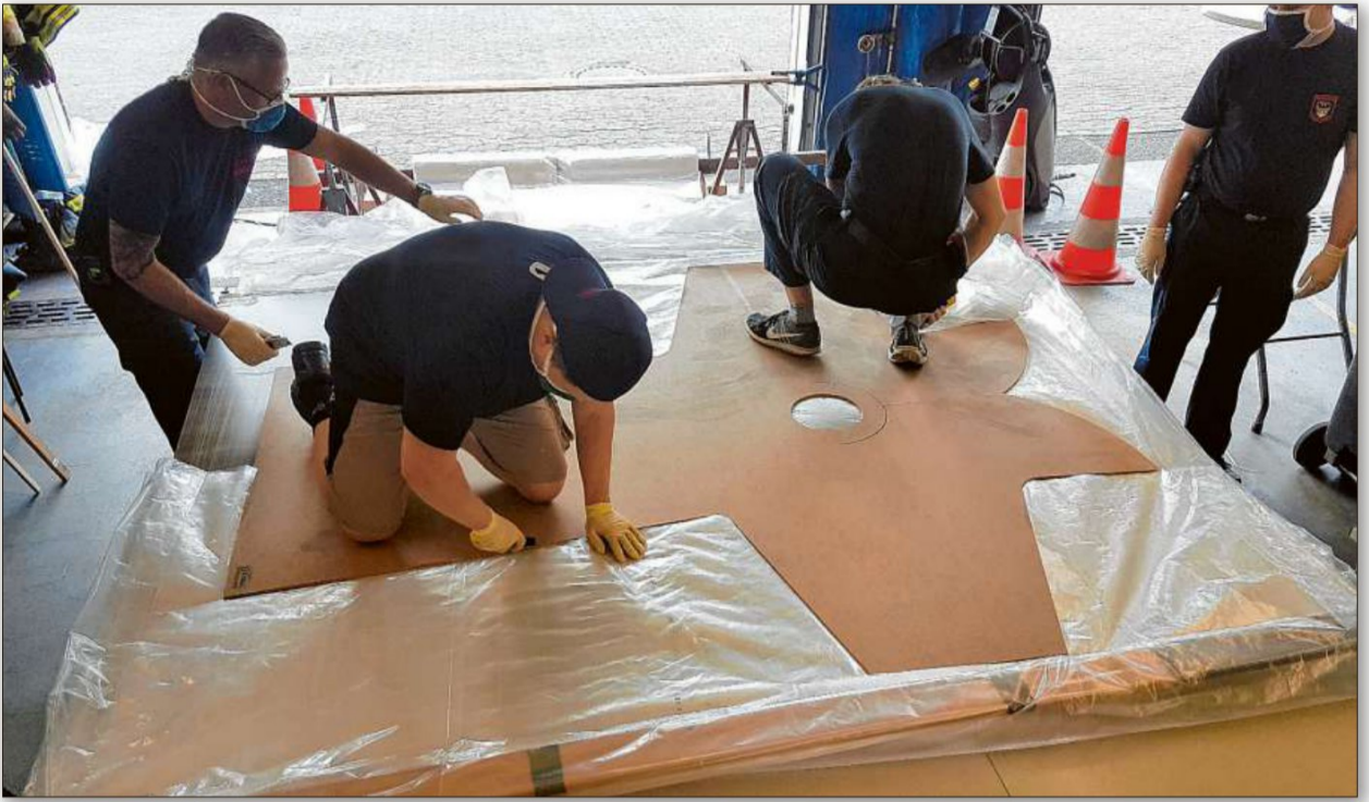
Schritt 1 – Auf zirka 20 aufgelegten Folien wird das überdimensionale Schnittmuster gelegt, „personell“ beschwert und sogleich das Cuttermesser gezückt. Fotos: Ferdi Seidelt
